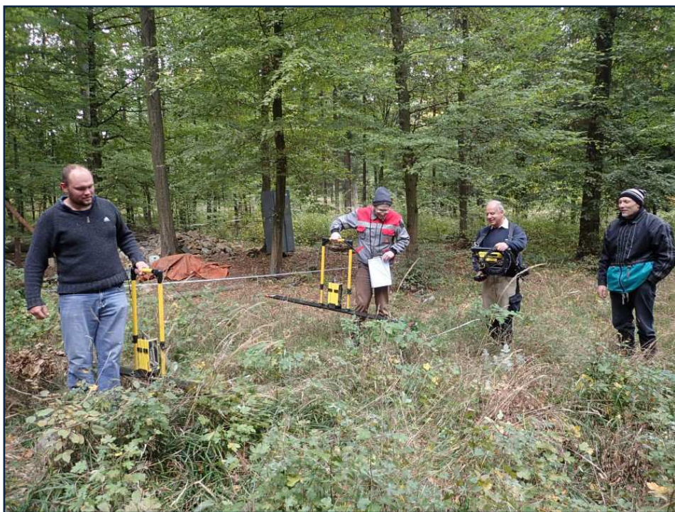
Georadarové měření na lokalitě
